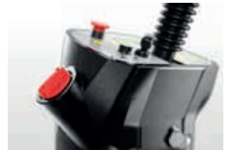
Unterbinden Sie wirkungsvoll die Ausbreitung von Staub: Entfernen Sie den roten Deckel und füllen Sie frisches Wasser in den Behälter zur Vernebelung über den Seitenbesen.
