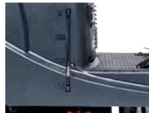
Gut sichtbare Anzeige für den Frischwasser-Füllstand.
