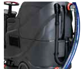
Platzsparende Aufbewahrung der Saugleiste. Somit ist ein Durchfahren enger Wege möglich.
